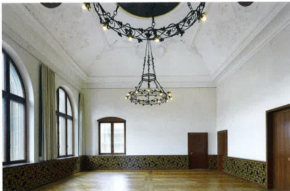
10 Musiksaal nach der Sanierung: Der Parkettboden weist neu eine Gliederung auf, das umlaufende Bord verbindet die nötigen technischen Installationen (Foto: Roger Frei)
